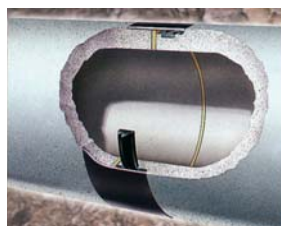
Obturador de hincado de tubos con gatos hidráulicos de aleta doble
